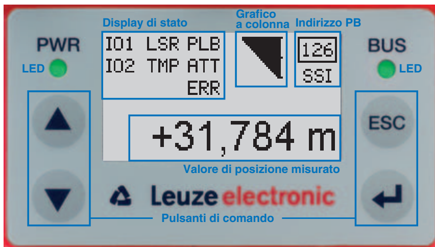
Figura 6.1: Struttura del pannello di controllo
